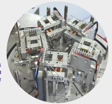
Jusqu'à 5 modules de pesée sont intégrés dans **THEMYS FLASH** pour la mesure simultanée de 5 échantillons. Les balances fonctionnent sur le principe de l'échantillon suspendu, qui améliore l'interaction gaz/échantillon avec une exposition maximum de l'échantillon à l'atmosphère d'analyse.
